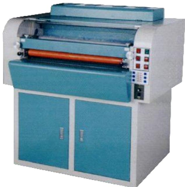
Esta barnizadora tiene la particularidad de realizar el proceso de barnizado con una solución líquida especial que da **ACABADO RUGOSO** al original.
