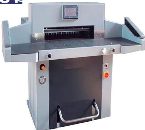
Guillotina de accionamiento hidráulico cuchilla y pisón para imprentas digitales.
